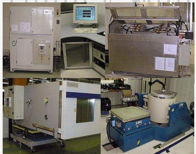
Banc d'essais de tuyaux avec pression et dépression pulsée eau, glycol, huile, combiné avec une enceinte climatique et un pot vibrant (débattement moteur) et simulation des températures sous capot (externe) et fluide (interne) année 1999-2000
