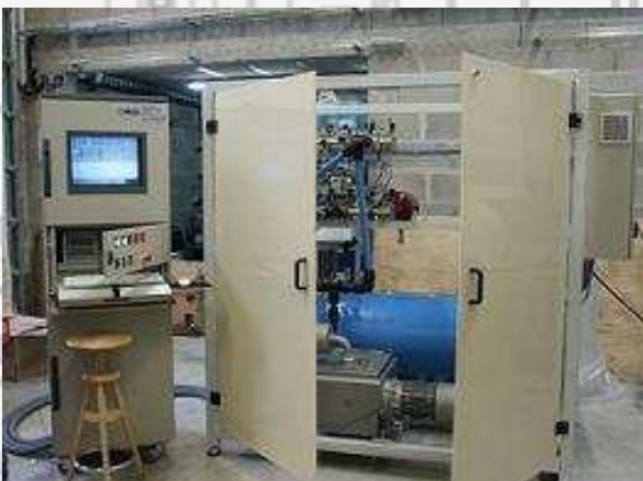
Banc d'essais pression cyclée pour tuyaux air avec simulation des débattement moteur, température sous capot, température fluide, et injection huile.
