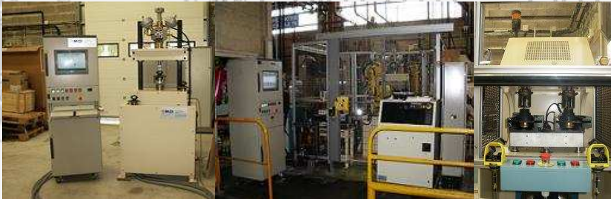
Machine d'essais servo-dynamique enlignée pour supports moteur ou autres pièces en élastomères (2005)
