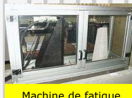
Machine de fatigue sur éprouvettes béton
