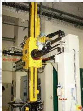
Rénovation du contrôle commande d'un robot manipulateur 2 axes
