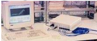
Surveillance de température d'étuves sur un réseau déporté
