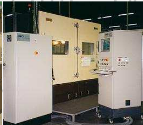
Rénovation des systèmes de contrôle commande de banc d'essais de soufflets de transmission pour l'automobile PST.
