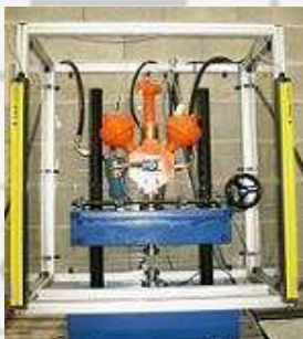
Banc de fatigue servo hydraulique mono axe pour contrôle de pièces en élastomère
