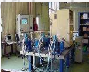
Banc d'essais de fatigue 3 axes servo-pneumatiques et 1 axe de rotation
