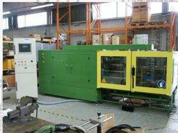
Banc d'essais de soufflets de transmission en cycles thermiques, avec simulation de la rotation, des angles de braquage côté boîte et côté roue, et coulissement (plunge)
