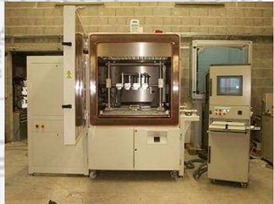
Banc d'essais pression cyclée pour tuyaux air avec simulation des débattements moteur, température sous capot, température fluide, et injection huile.
