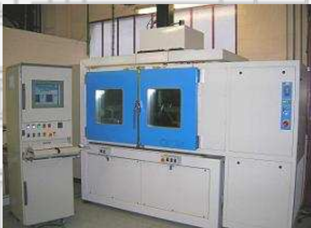
Banc d'essais de soufflets de direction avec sollicitations en rotation (braquage), sollicitations en débattement (suspension), et sollicitations en températures
