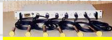
Rack de conditionnement de micros de mesure
