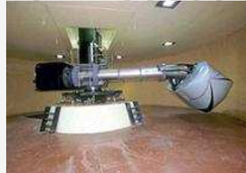
Système d'acquisition 32 voies synchrones 16 bits 1 Mhz embarqué sur centrifugeuse
