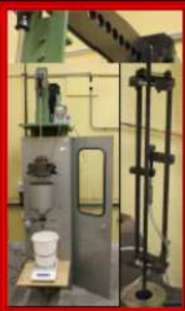
Système d'acquisition de bancs d'essais de relaxation d'armatures
