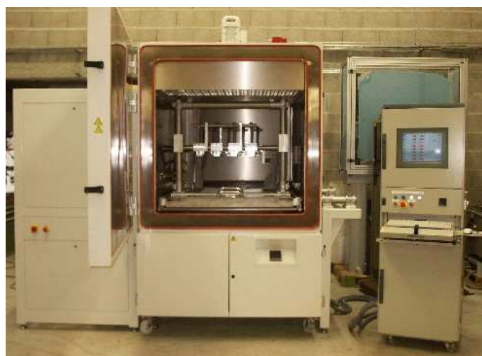
Banc d'essai de tuyaux d'admission d'air, piloté avec DASYLab
